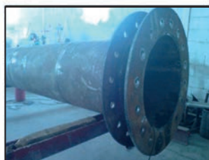
Unilube - Chimney 20M x 36" Dia. Base
